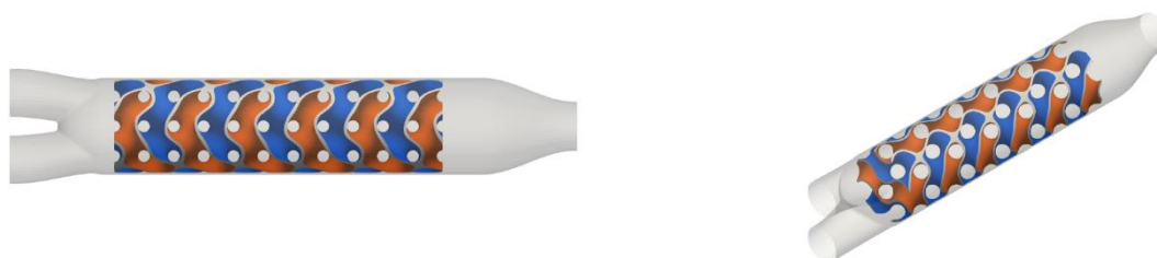
Σχήμα 6.4: Περίπτωση 9 η - Αναμίκτης με γυροειδές μειωμένου βασικού μήκους κατά μήκος ολόκληρου του αγωγού - Γεωμετρία αναμίκτη.
