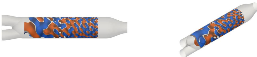
Σχήμα 6.15: Περίπτωση 12 η - Αναμίκτης με γυροειδές μεταβλητού μεγέθους βασικού δομικού στοιχείου γυροειδούς και συστροφή 180°- Γεωμετρία αγωγού.
