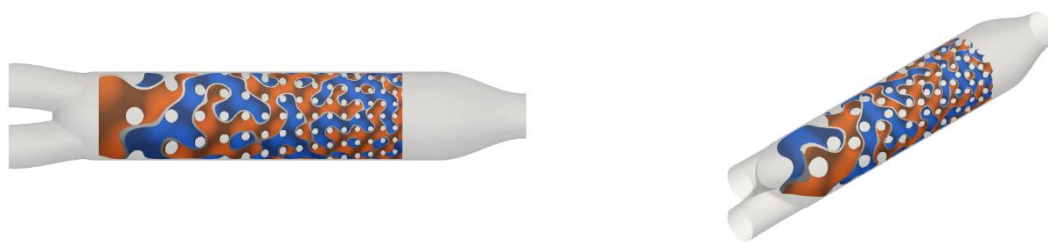
Σχήμα 6.8: Περίπτωση 10 η – Αναμίκτης με γυροειδές μεταβλητού μεγέθους βασικού δομικού στοιχείου γυροειδούς – Γεωμετρία αναμίκτη.
