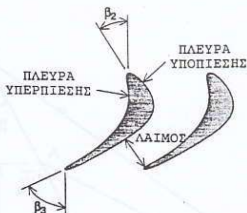
Σχήμα 8.2.3 Δημιουργία ηχητικού λαιμού σε πτερύγωση αξονικού στροβίλου.
